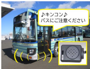
安全確認放送装置
